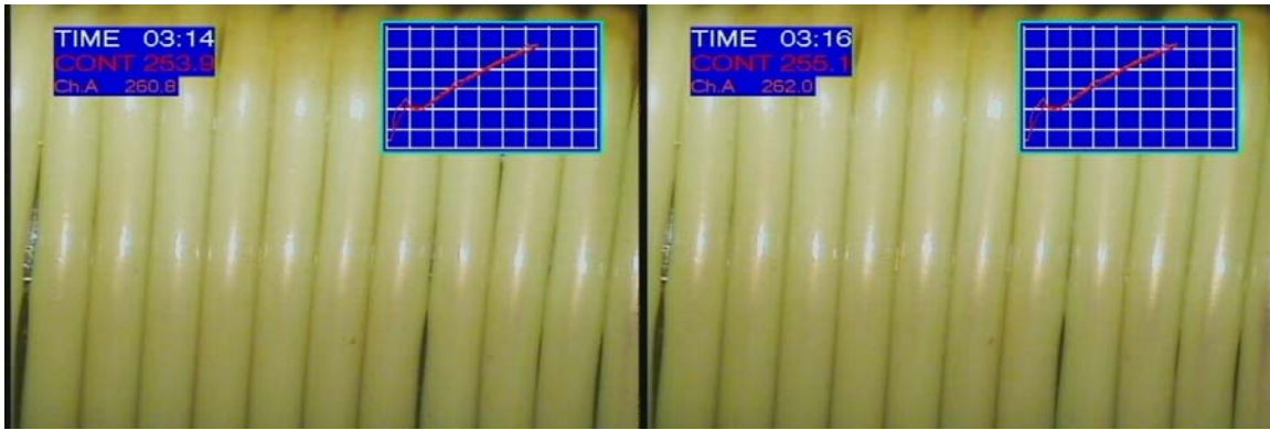
Photo3(e): TEX-E 0.20mm 261°C (bobbin 254°C) Photo3(f): TEX-E 0.20mm 262°C (bobbin 255°C)
